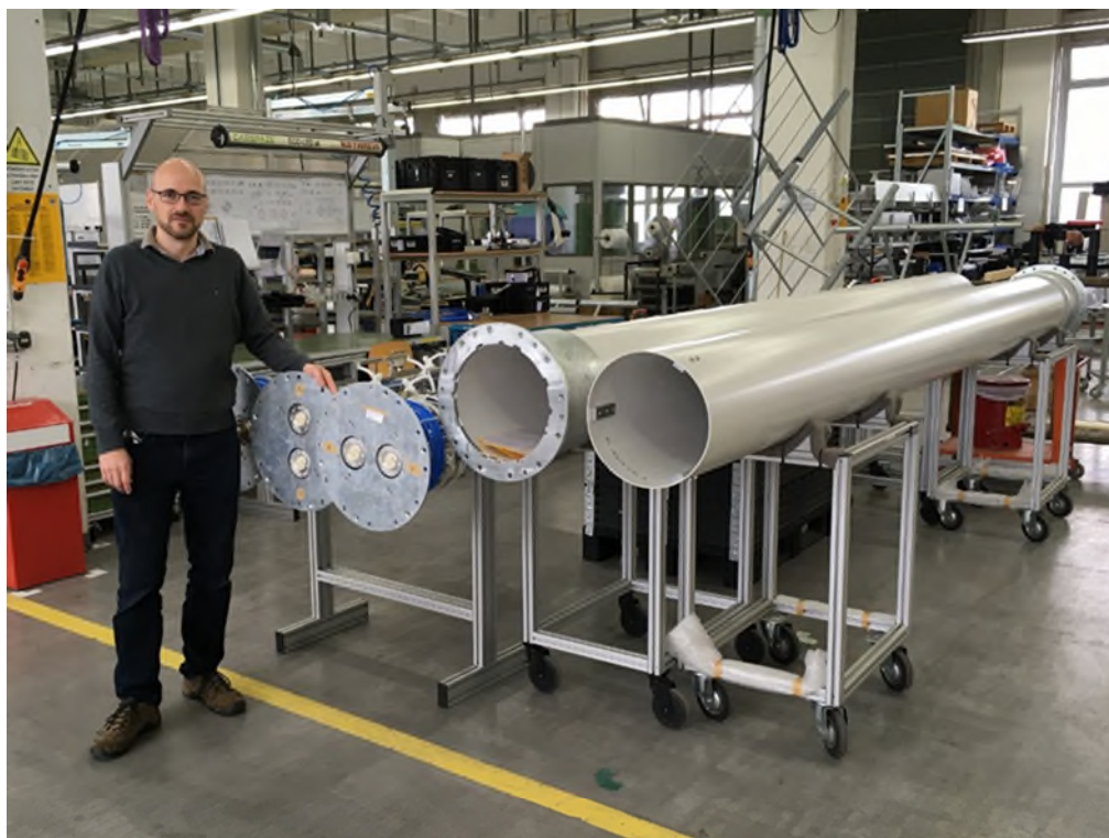
im Bild: Markus Gerl, Projektmanager für den US-Markt, vor einer Reihe neuer dual polarisierten UHF Omni-Antennen. Gut zu erkennen: die beiden separaten Eingänge für horizontale und vertikale Polarisation.
